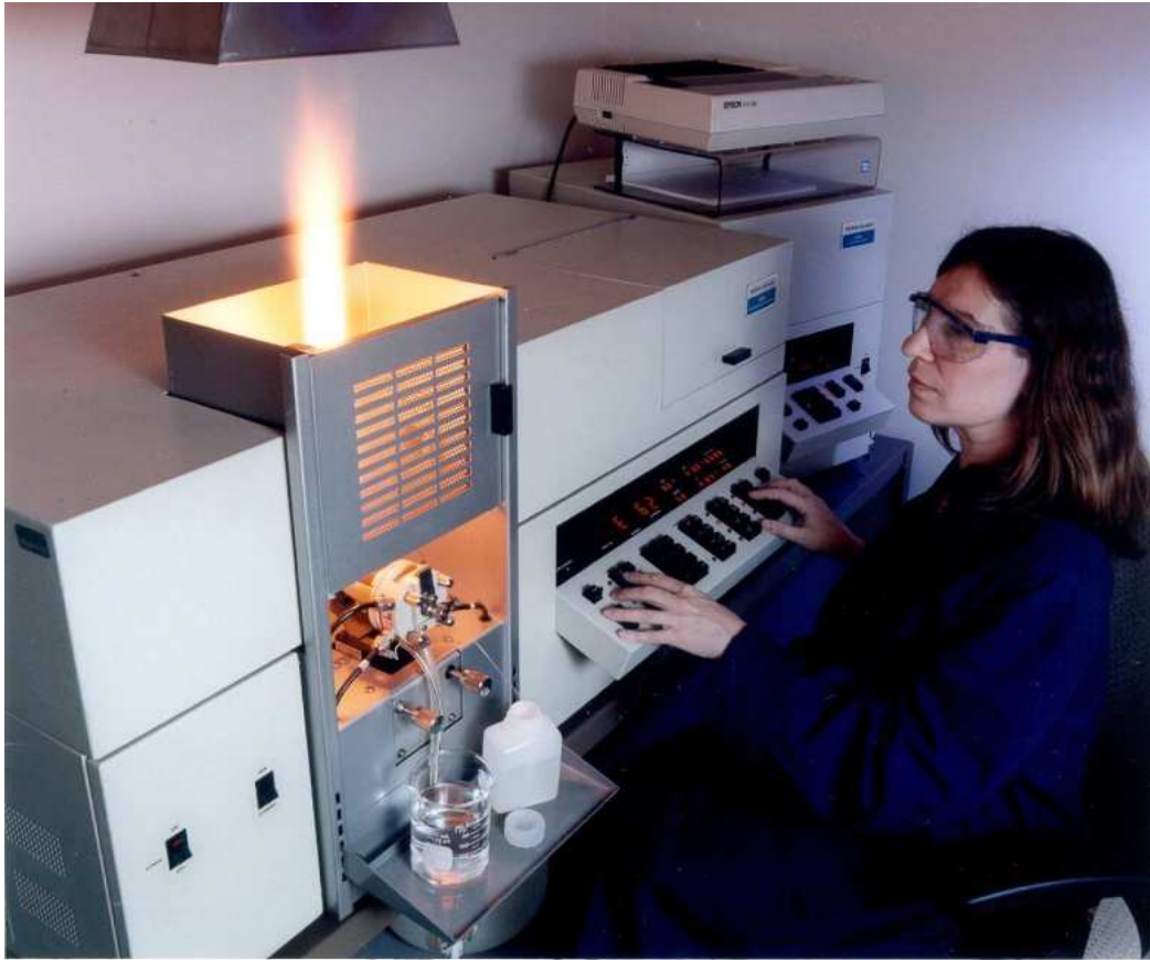
图表 3: 原子吸收光谱仪常用于定量元素分析。先放置某一固体于溶液中，再由机器吸取至热源里，接着开始实验；不同元素可以通过图谱和波长分辨出来，也能测量该元素的光吸收能力。
