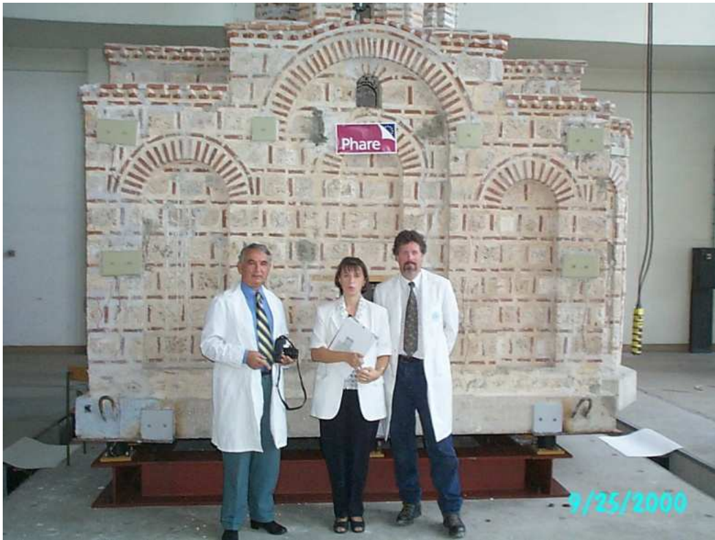
图表 4: 图为Sveti Nikita near教堂1:2.75比例模型，以及由Predrag Gavrilovic教授领军的多专业团队，位于临近马其顿史高比城市的马其顿共和国地震工程与工程地震研究所。
